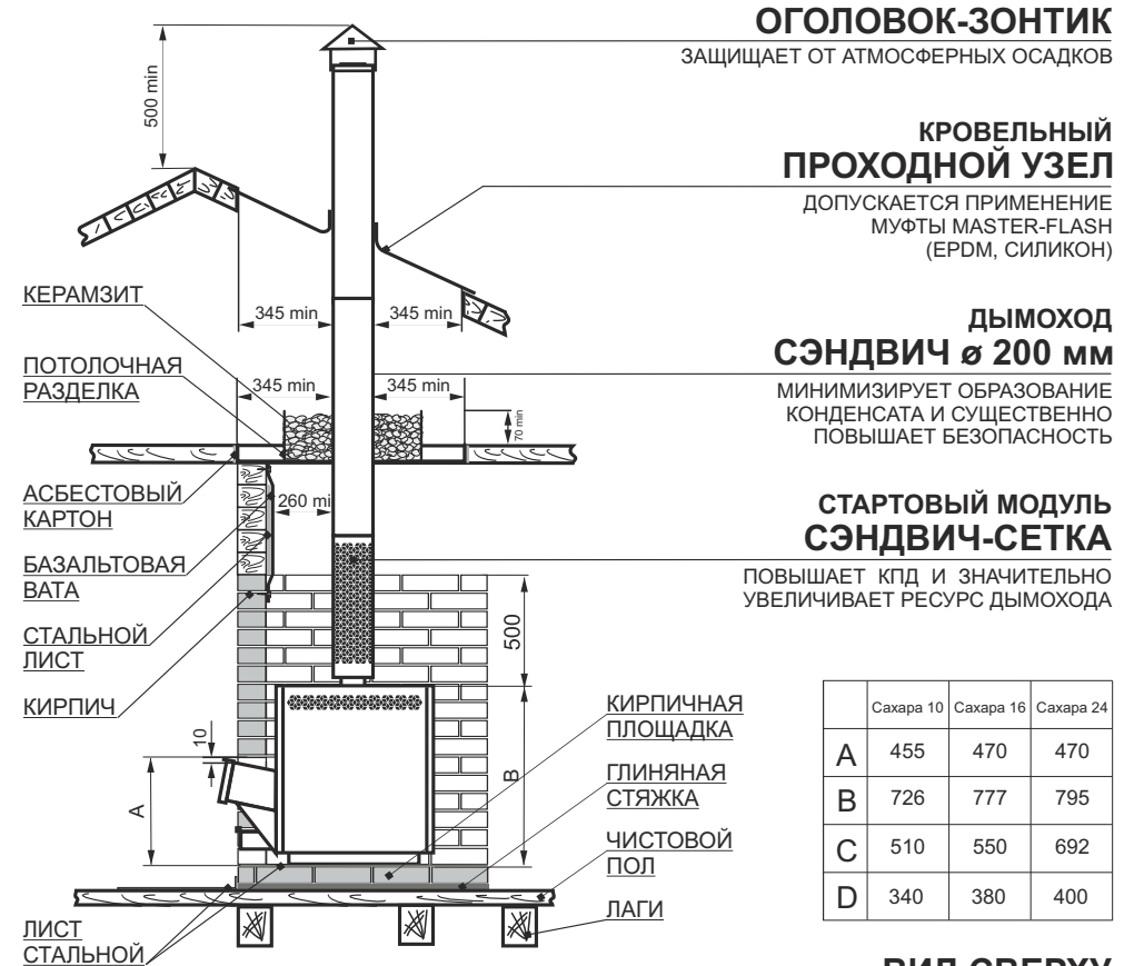
ПЕЧИ САХАРА-10, 16, 24 С БАКОМ "САМОВАРНОГО" ТИПА, УСТАНОВЛЕННЫМ НА ОСНОВАНИЕ ДЫМОХОДА
