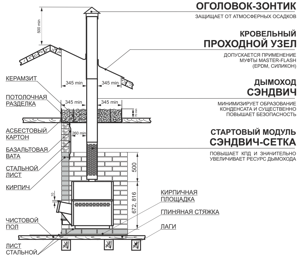
ПЕЧИ РУСЬ-12/18 С БАКОМ "САМОВАРНОГО" ТИПА, УСТАНОВЛЕННЫМ НА ОСНОВАНИЕ ДЫМОХОДА
